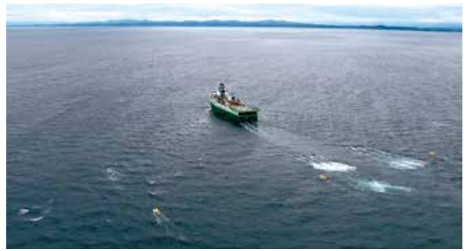
船舶による弾性波探査の様子
