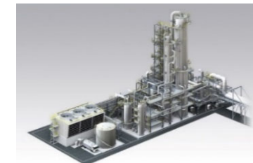
CO2回収実証プラント 1日600トン以上回収(2020年運転開始)
