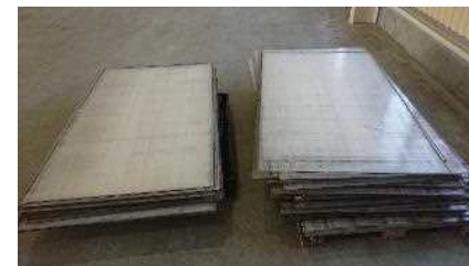
図.ホットナイフ分離法による廃PVリサイクル
