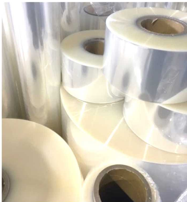
原料廃プラスチック（フィルムの製造ロス）
