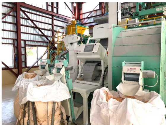
導入設備のガラス選別機部分
