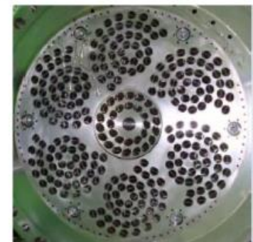
マルチクラスタ燃焼器（出典；MHPS）
