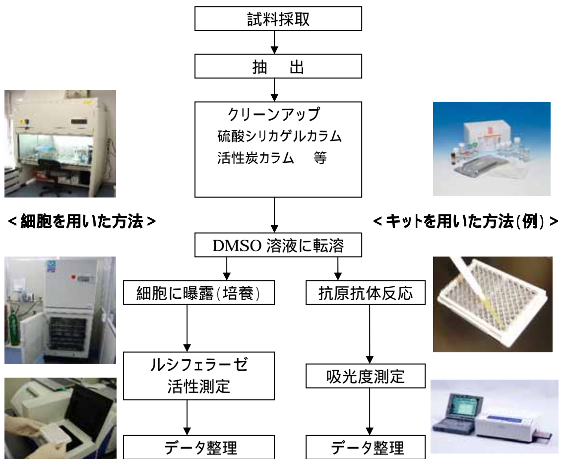
図1 生物検定法によるダイオキシン類簡易測定技術のフローチャート
