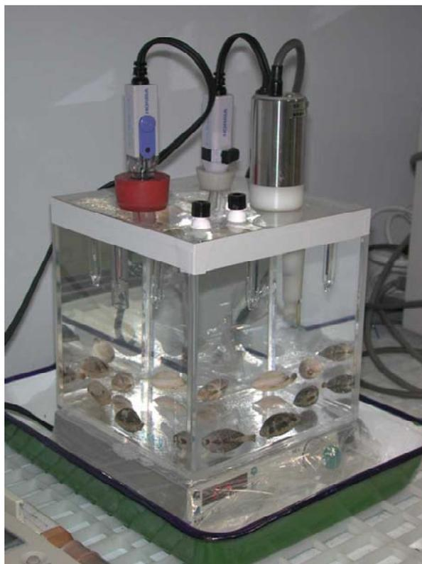
培養庫内でのアサリおよびアオサの呼吸速度試験・硫化水素発生試験
