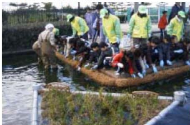
下水処理水の植生浄化実験
