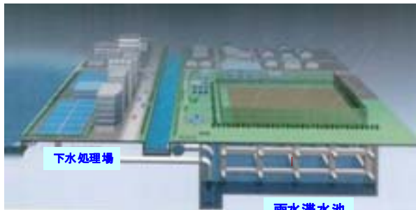
貯留施設の整備
