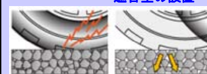
低騒音舗装の敷設
