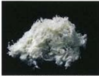
白石綿(クリソタイル)
