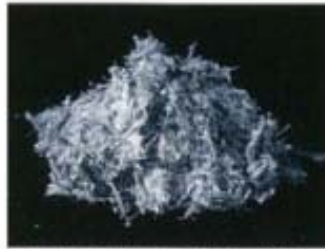
青石綿(クロシドライト)
