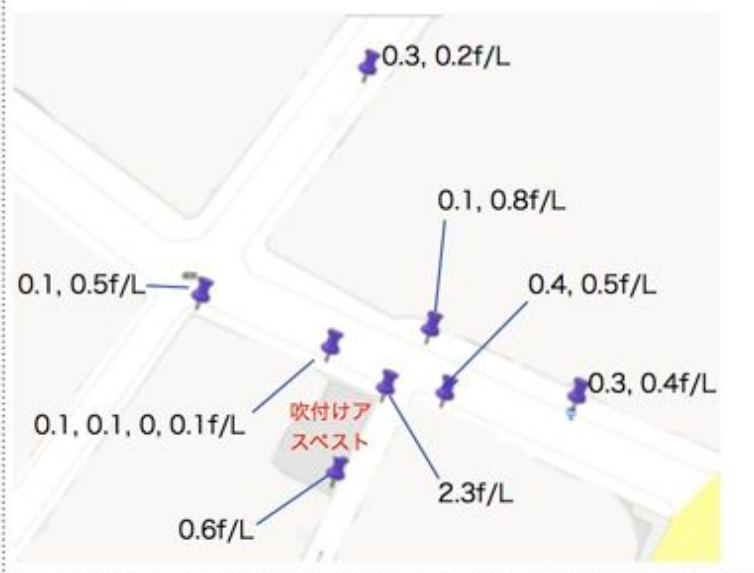
図3：吹付けアスベストのある建物周辺の空中アスベスト濃度
