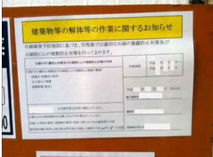
ホテル 機械室に吹き付け岩綿・配管に保温材など考えられるが成形板等のみの解体現場という表示になっている。
