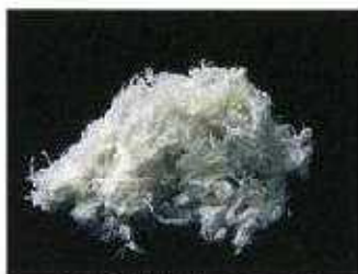
白石綿(クリソタイル)
