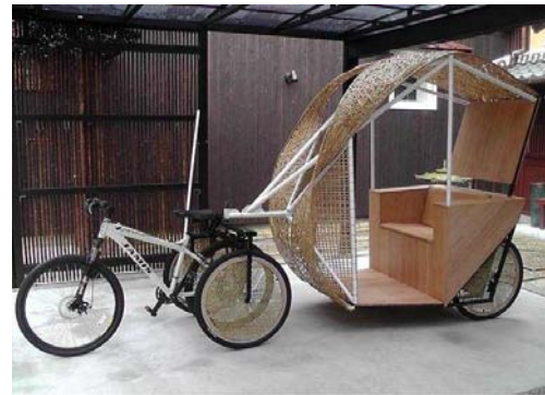
廃竹材を利用した観光用力車の製作
