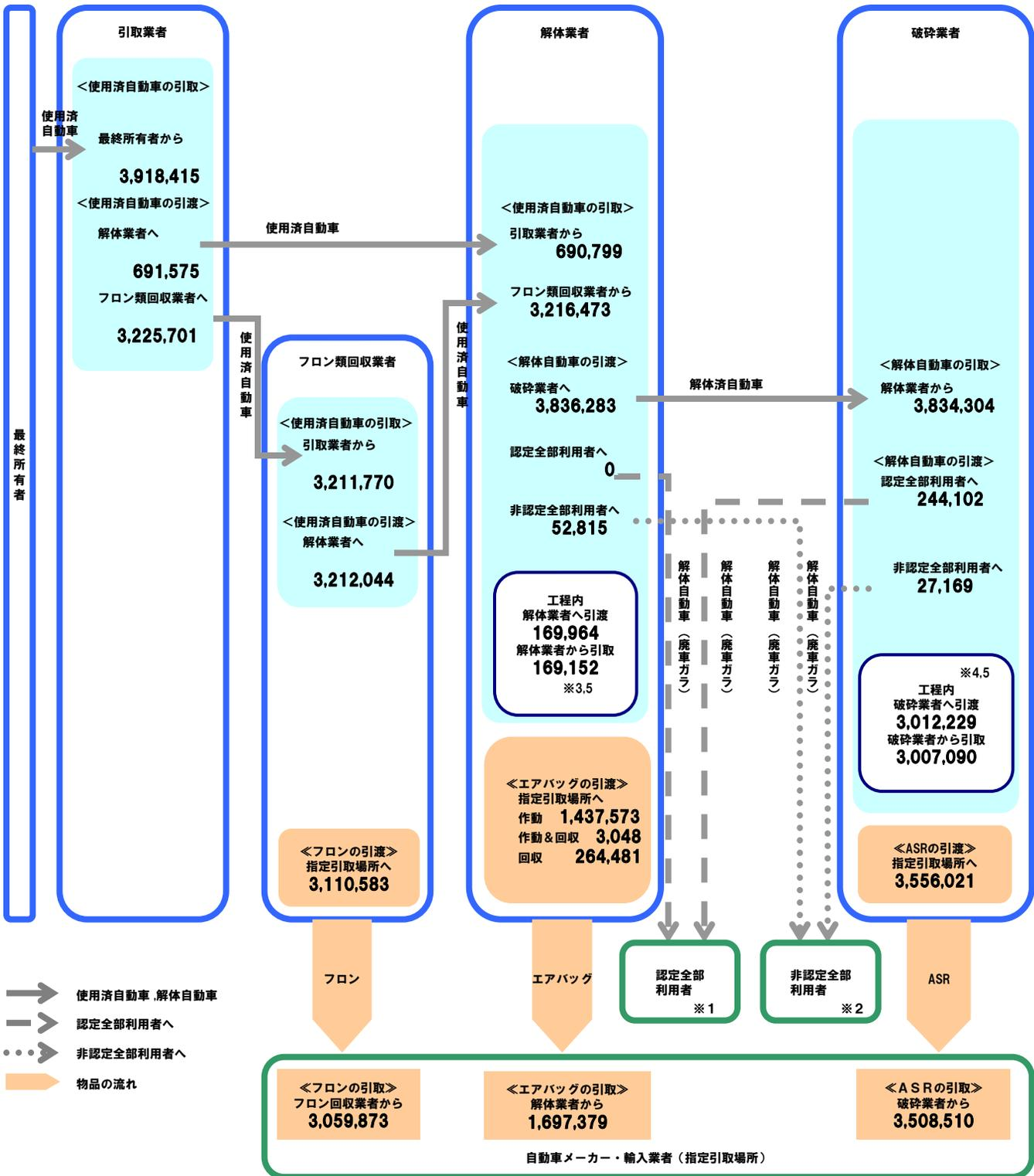
※1. 認定全部利用者 …… 主務大臣の全部再資源化認定（法第31条認定）を受け、電炉・転炉に解体自動車（廃車ガラ）を鉄鋼の原料として投入しリサイクルする業者。
