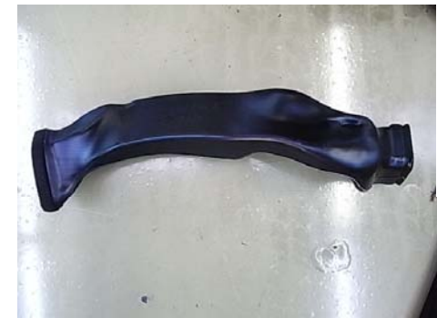
室内空調ダクト
