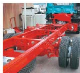
シャシ上塗り塗装の鉛フリー塗料への切替え
