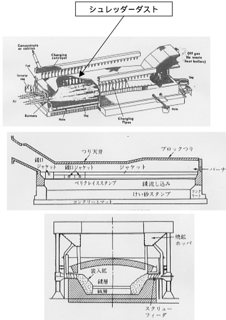
図 - 2 - 溶解炉（銅製錬用）の構造
