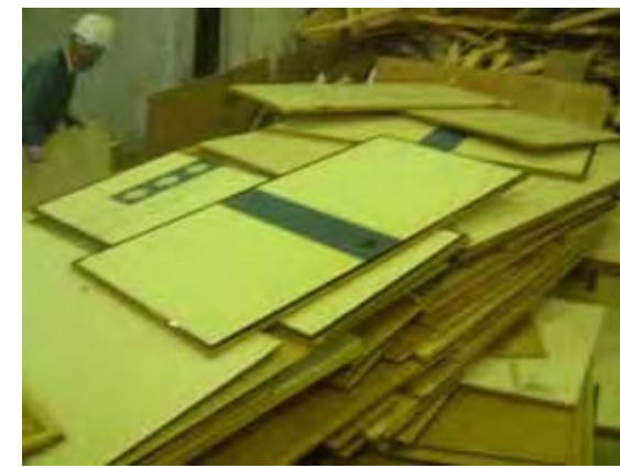
ふすま(板に塩ビクロスが糊付け)
