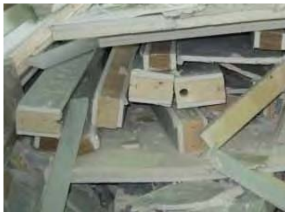
木くずと石膏ボードの複合材
