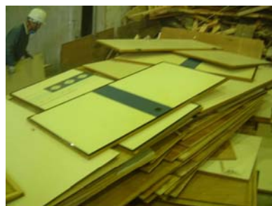
ふすま(板に塩ビクロスが糊付け)
