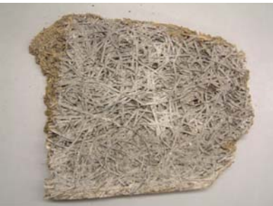
セメント木毛板(セメントとチップの混合材)
