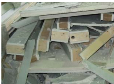
木くずと石膏ボードの複合材
