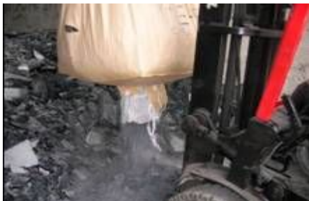
図11 精製CRT硝子取出し
