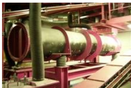
図5 乾式硝子精製
