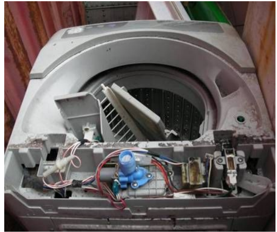
【フタ部分が破損している洗濯機】
