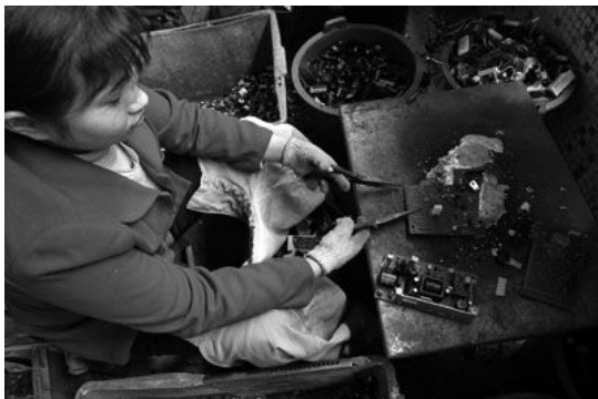
はんだを溶かして基板から部品を取り外す
