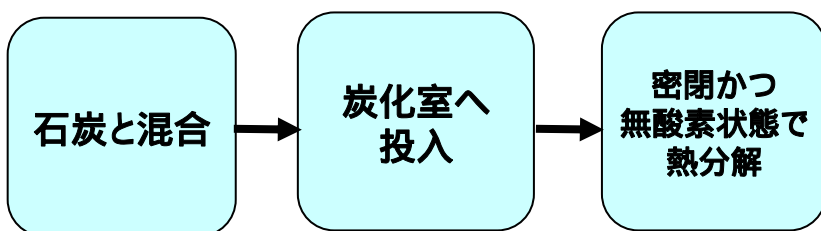
コークス炉の構造と熱分解進行状況
