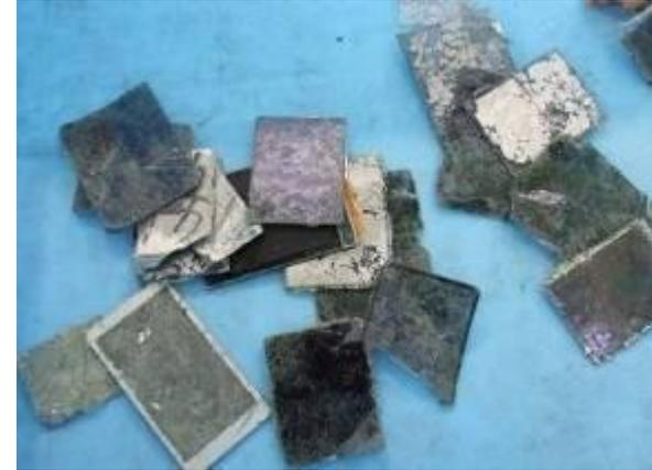
携帯電話の液晶：機械解砕後
