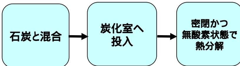
コークス炉の構造と熱分解進行状況
