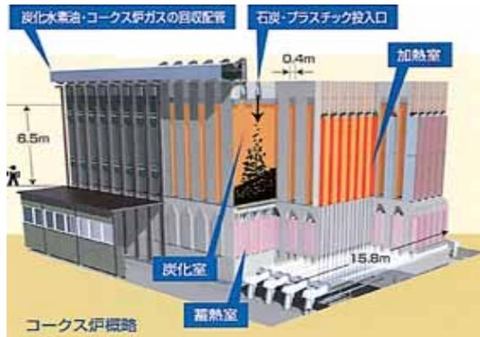
熱分解処理によって石炭の揮発分を除去し強固なコークスを製造する設備です。
