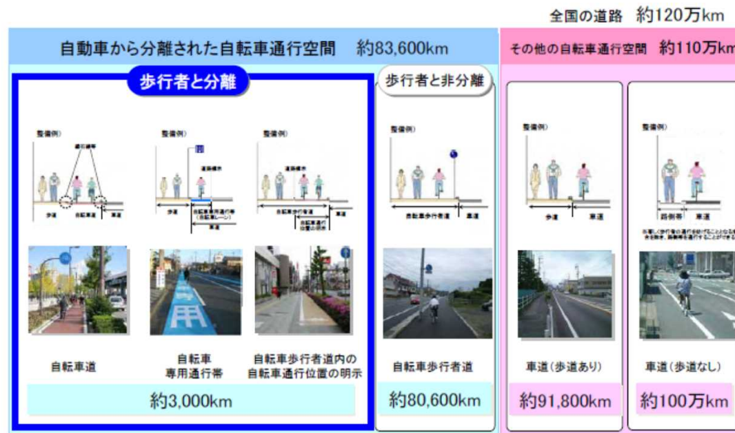
自転車通行空間の整備状況(延長は道路延長。平成22年3月時点)
