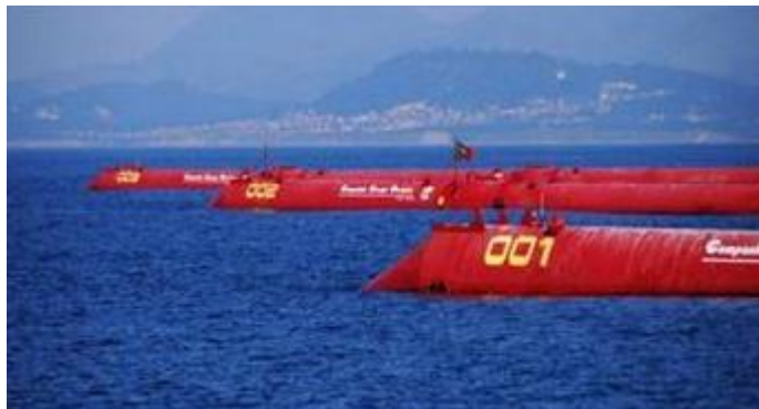
図 Pelamis 波力発電装置
