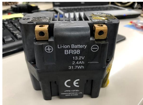
2輪(YAMAHA)用既搭載済みの始動用Li-ionバッテリー (外寸90×110×70)
