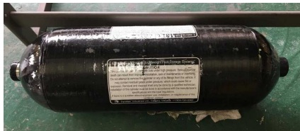
CFRP製水素タンク
