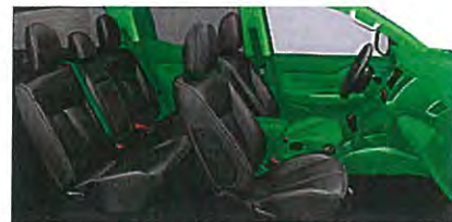
2014年発売新型ライトトラックにおけるリサイクル容易な熱可塑性樹脂の主な採用箇所(グリーン部)
