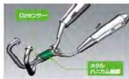
O 2 センサーとメタルハニカム触媒を搭載したマフラー
