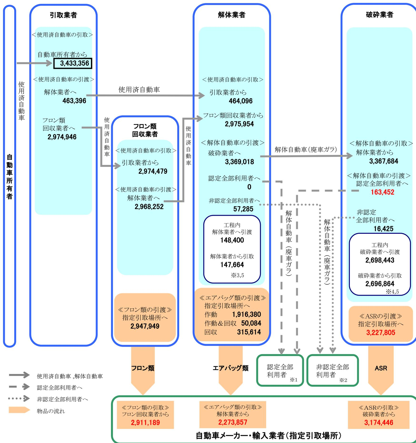
※1. 認定全部利用者 … 主務大臣の全部再資源化認定(法第31条認定)を受け、電炉・転炉に解体自動車(廃車ガラ)を鉄鋼の原料として投入しリサイクルする業者。
