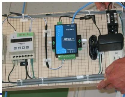
電力量計と変換器
