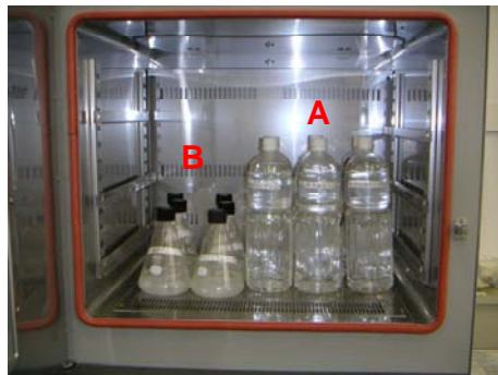
図3. 純水、50%エタノール溶液、4%酢酸溶液を用いた溶出実験（49°Cで30日間保温）
