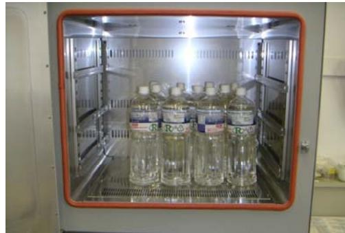
図1. 0.1wt%代理汚染物質水溶液を用いたPETボトルの汚染実験（40°Cで14日間保温）
