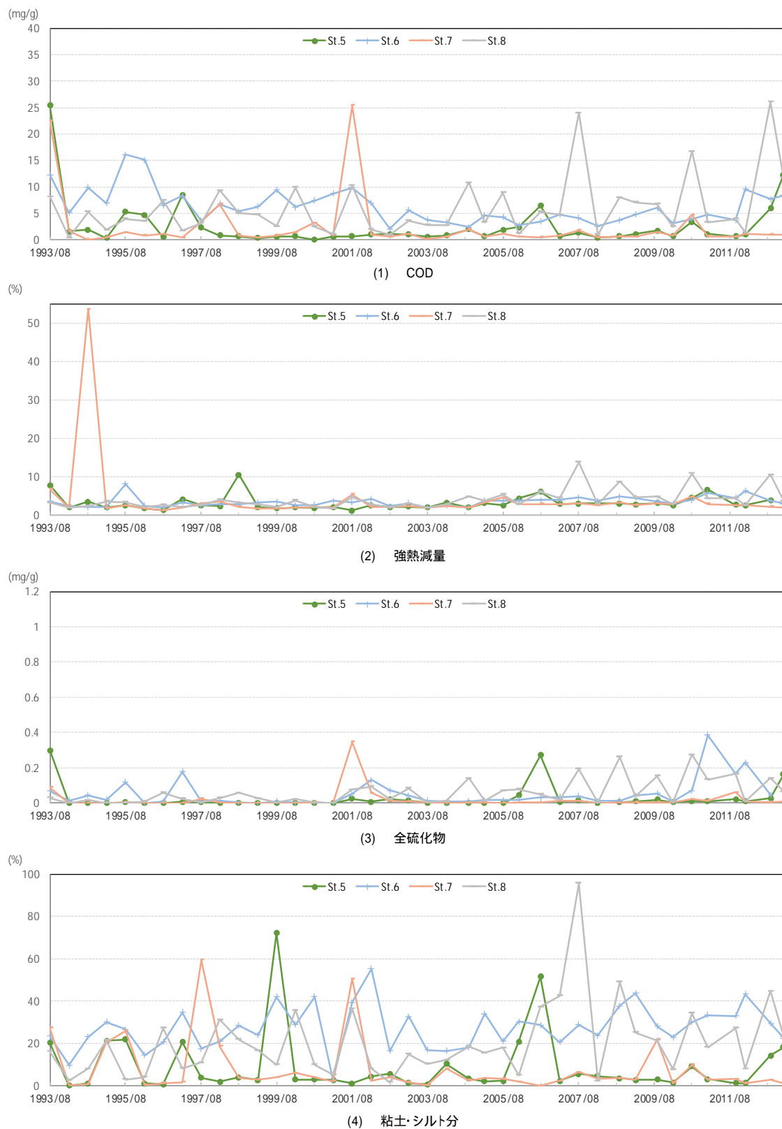
図 7(2) 熊本地先における底質の推移 (図 4 熊本地先におけるベントスの推移と同一地点)
