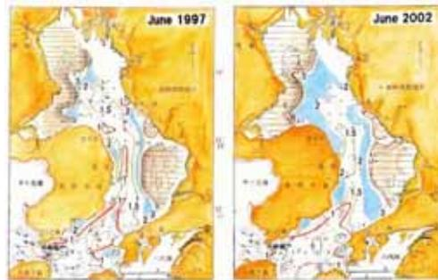
有明海全域海床堆積物の中央粒径値Mdφ等値線図の1997年6月と2002年6月の比較(0-9はφ, 破線・点線の数字は水深m)
