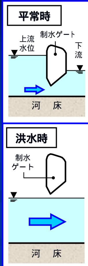
平常時はアンダーフローを主体に、洪水時は全開状態としている。
