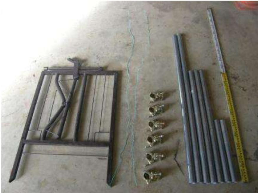
捕獲後にネットに負荷がかからないよう、鋼管パイプを地面に埋め込み、鋼管パイプとセルフロックスタンションを番線で固定
