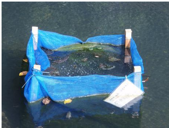
藻類の回復試験 左:外来魚なし 右:外来魚あり 外来魚なし試験区(左)では藻類が成長
