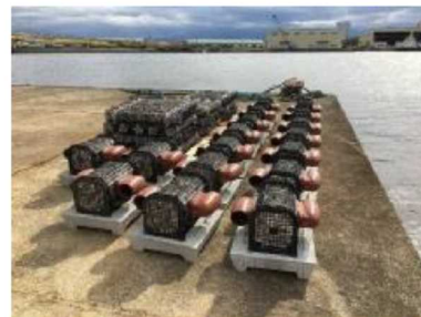
事業②：貝殻基質ユニットを用いた生物生息の場の創出
