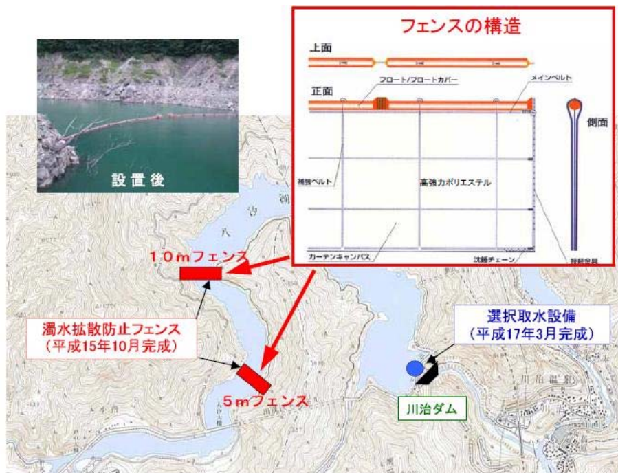
図 2.8 濁水拡散防止フェンスの設置状況
