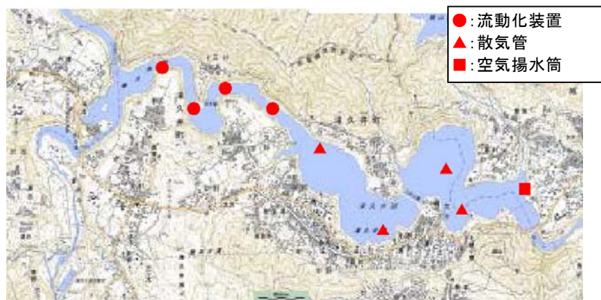
図 9.9 城山ダム（津久井湖）曝気循環装置設置位置
