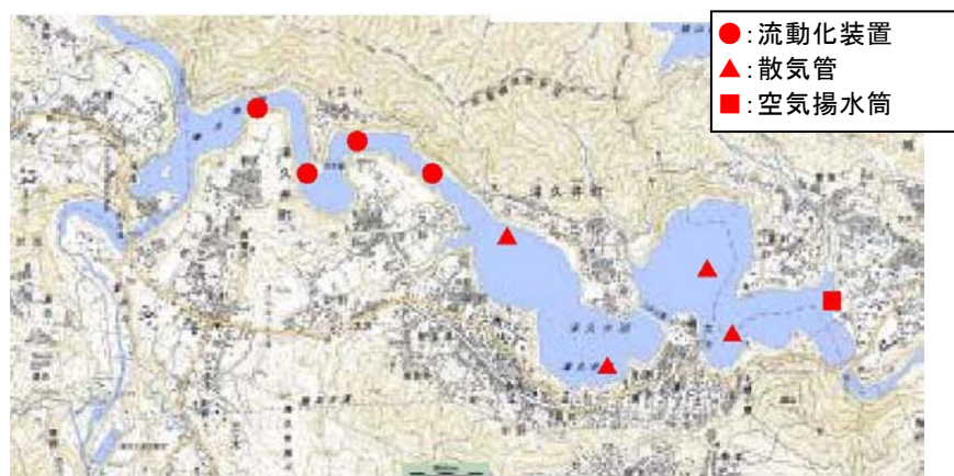
図 2.9 城山ダム（津久井湖）曝気循環装置設置位置
