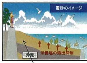
浚渫土砂により汚泥を封じ込め 栄養塩の溶出抑制
