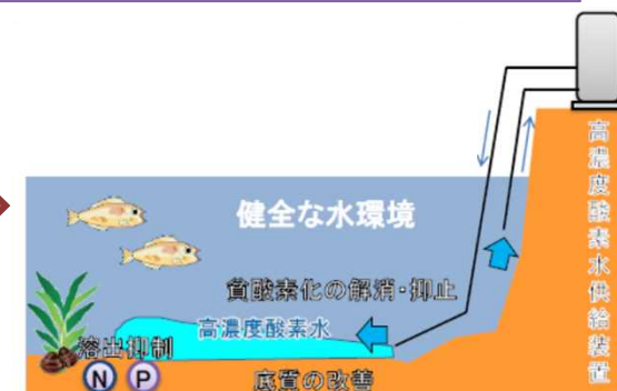
高濃度酸素水供給装置による底層溶存酸素改善効果の検証
