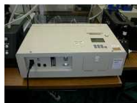
図 3. 131 繊維状粒子自動計測器の例
