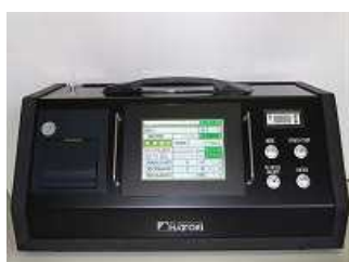
図 3. 131 繊維状粒子自動計測器の例
