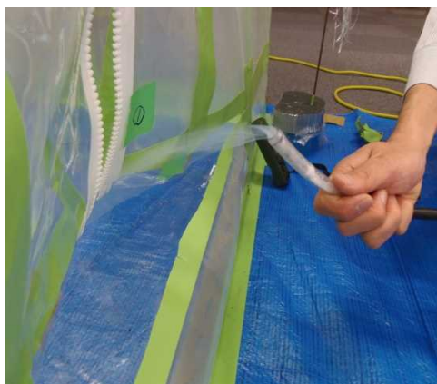
図 3.121 スモークテスターによる確認
