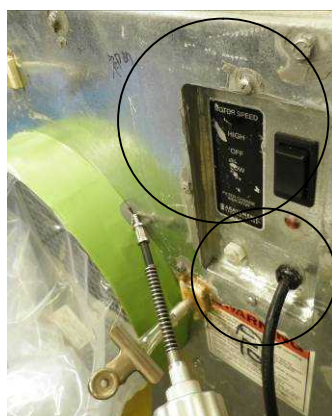
図 3.78 漏れの発生しやすい箇所の例
