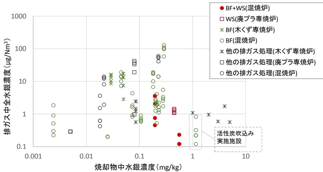
図 II-4-1-9 排ガス処理設備ごとの焼却物中水銀濃度と全水銀濃度
