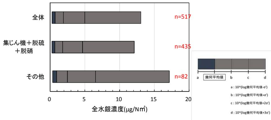
図 II-1-25 排ガス処理設備の種類ごとの水銀濃度（対数標準偏差）
