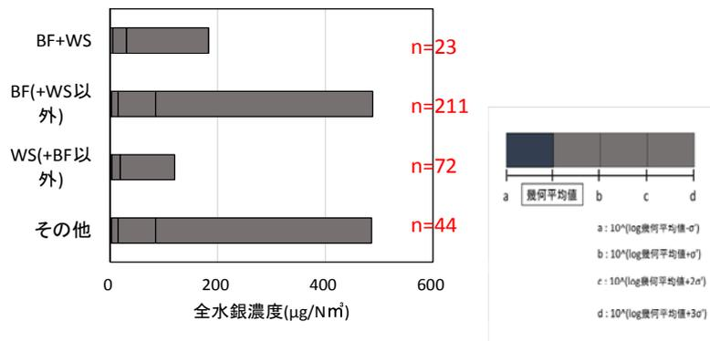
図 II-4-1-8 対数標準偏差による排ガス処理方式と全水銀濃度
