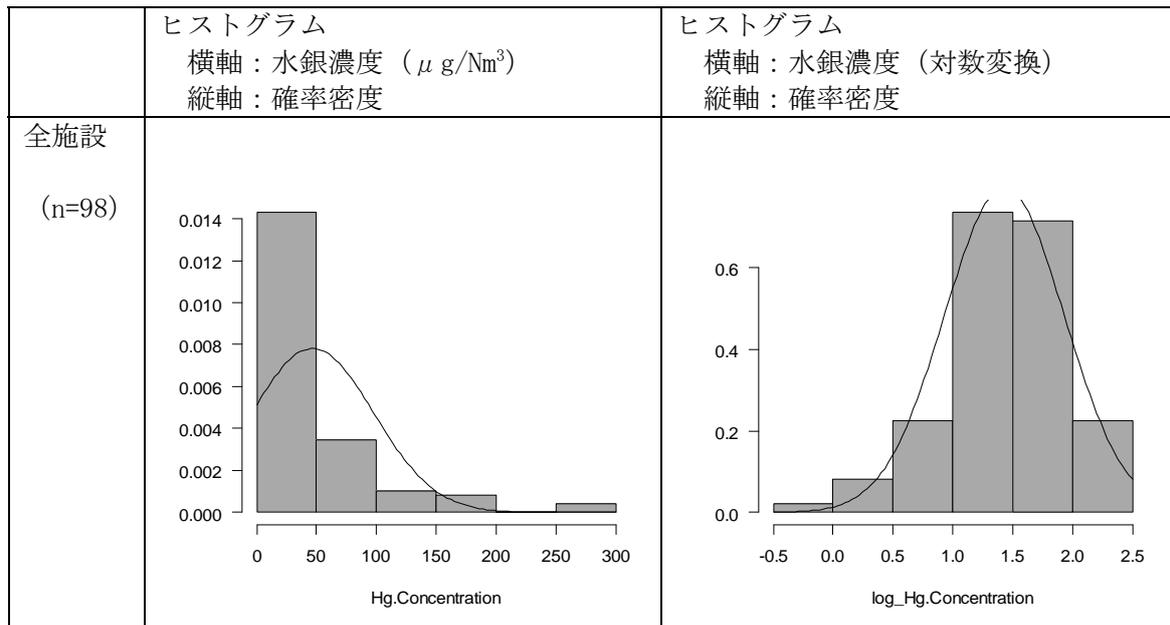
図Ⅲ-2-7 排ガス中の水銀濃度（全水銀）のヒストグラム（セメント製造施設）
