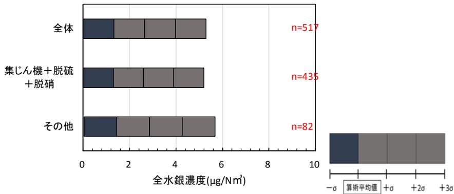
図 II-1-24 排ガス処理設備の種類ごとの水銀濃度（小型石炭混焼ボイラー以外）
