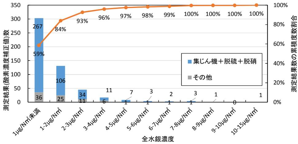
図 II-1-23 排ガス処理設備の種類と水銀濃度（小型石炭混焼ボイラー以外）
