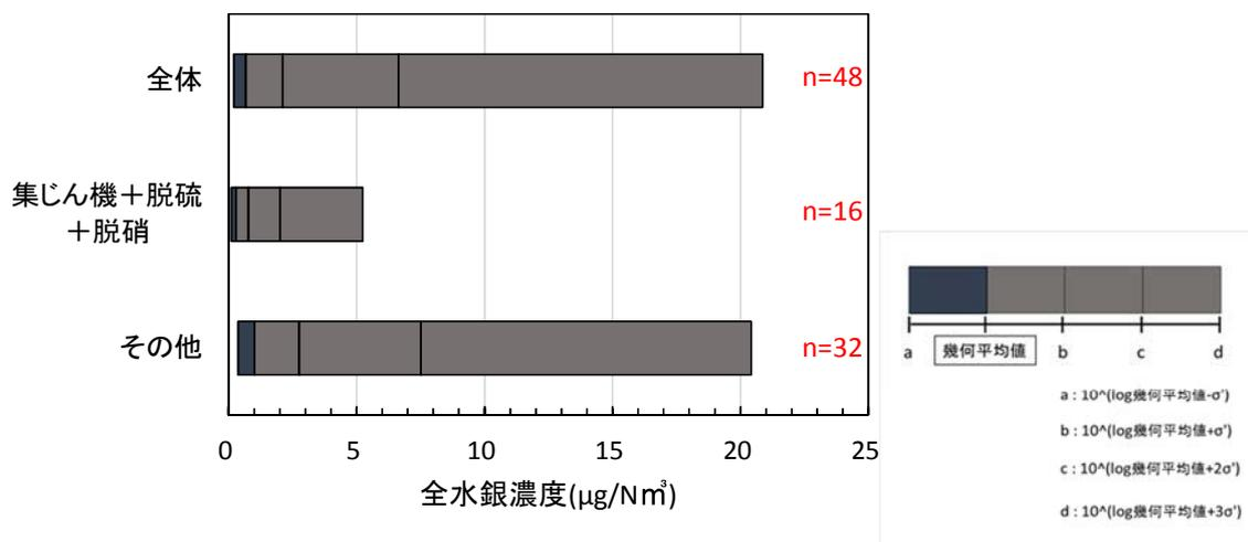
図 II-1-22 排ガス処理設備の種類ごとの水銀濃度 (対数標準偏差)
