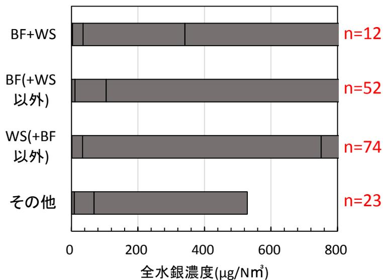
図 II-4-1-19 排ガス処理方式と全水銀濃度（産業廃棄物焼却炉）
