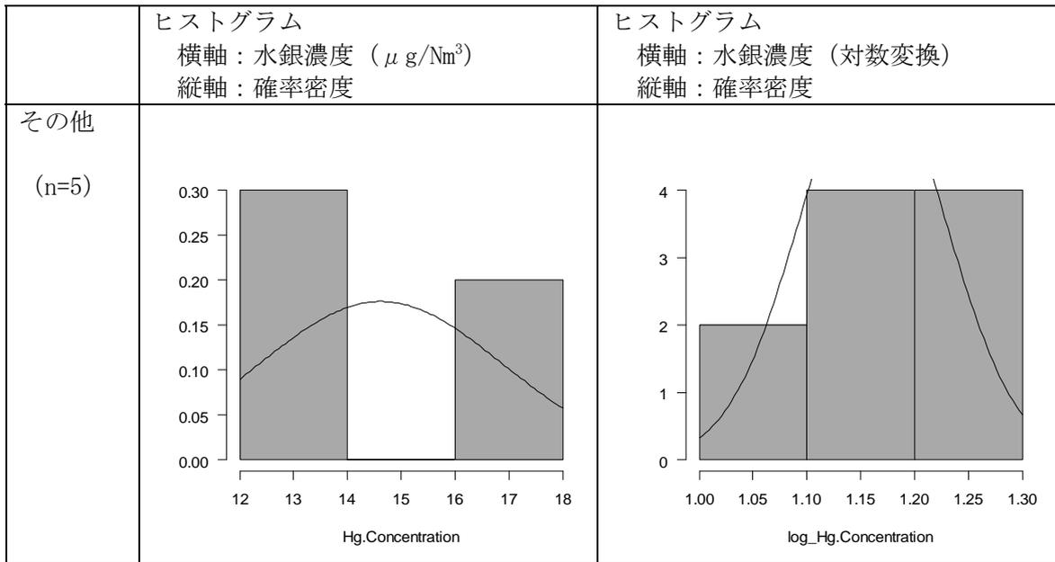
図Ⅲ-2-6 排ガス中の水銀濃度（全水銀）のヒストグラム（下水汚泥焼却炉）（2/2）
