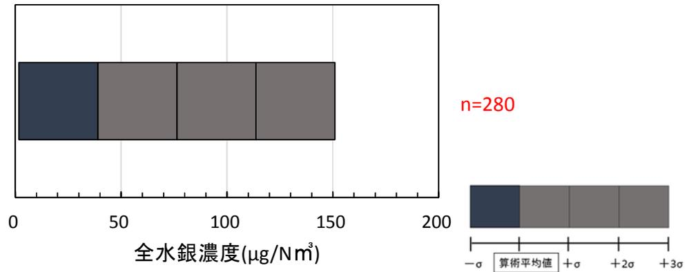
図 II-5-11 セメントクリンカー製造設備の排ガス中全水銀濃度（環境省法以外）
