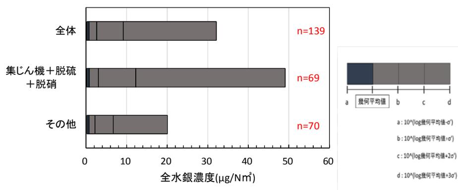
図 II-1-10 排ガス処理設備の種類ごとの全水銀濃度 (対数標準偏差)
