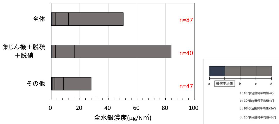
図 II-1-13 排ガス処理設備の種類ごとの全水銀濃度（対数標準偏差）
