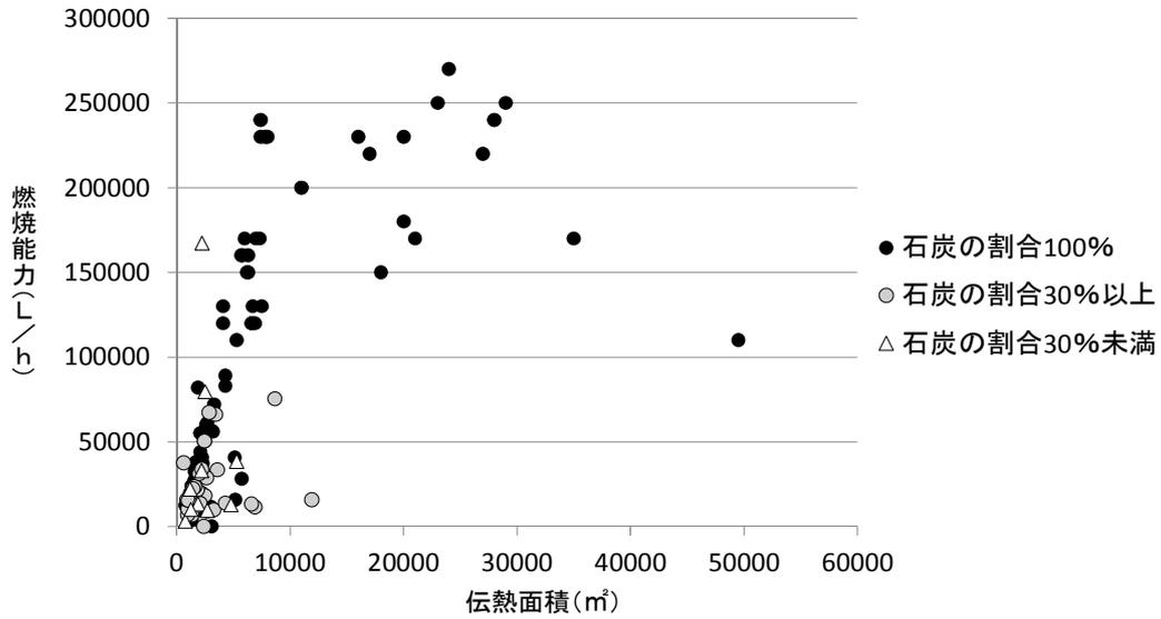
図 II-1-3 燃焼能力と伝熱面積の関係
