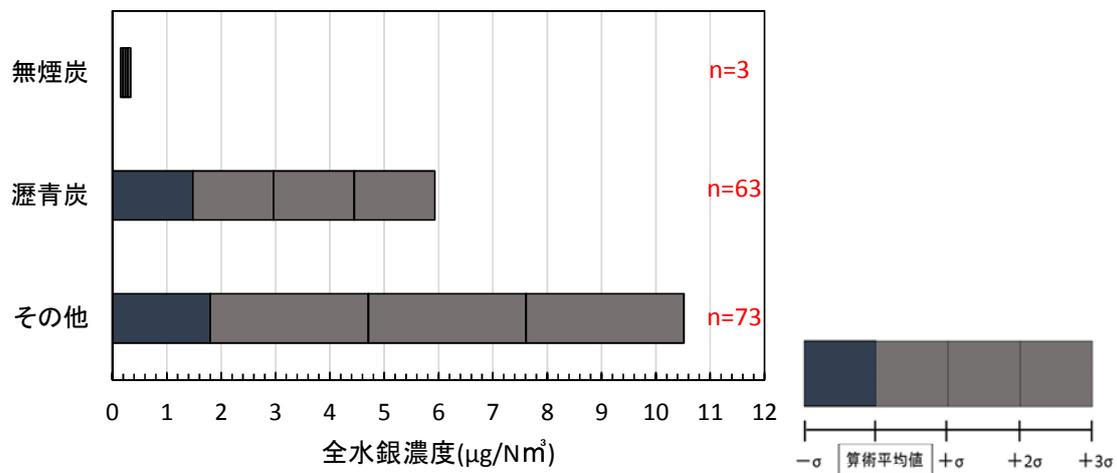
図 II-1-17 使用石炭の種類と全水銀濃度
