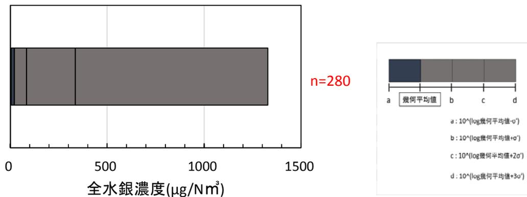
図 II-5-12 セメントクリンカー製造設備の排ガス中全水銀濃度（対数標準偏差）
