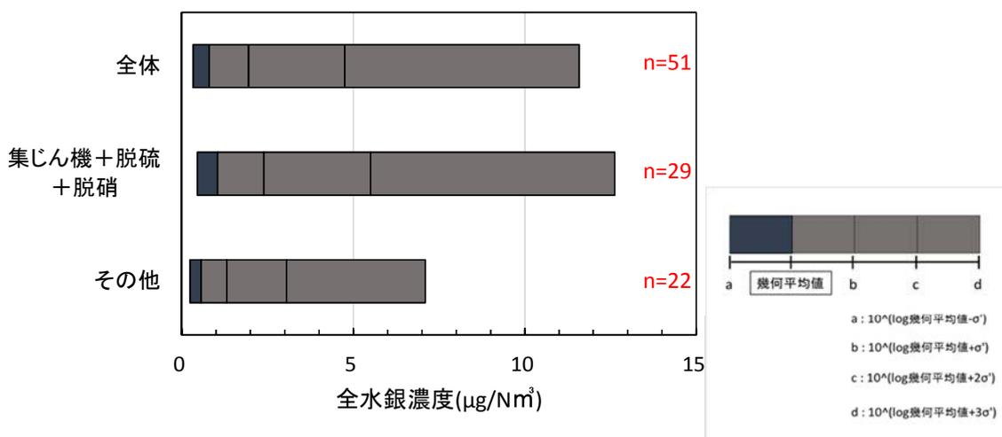
図 II-1-16 排ガス処理設備の種類ごとの全水銀濃度（対数標準偏差）
