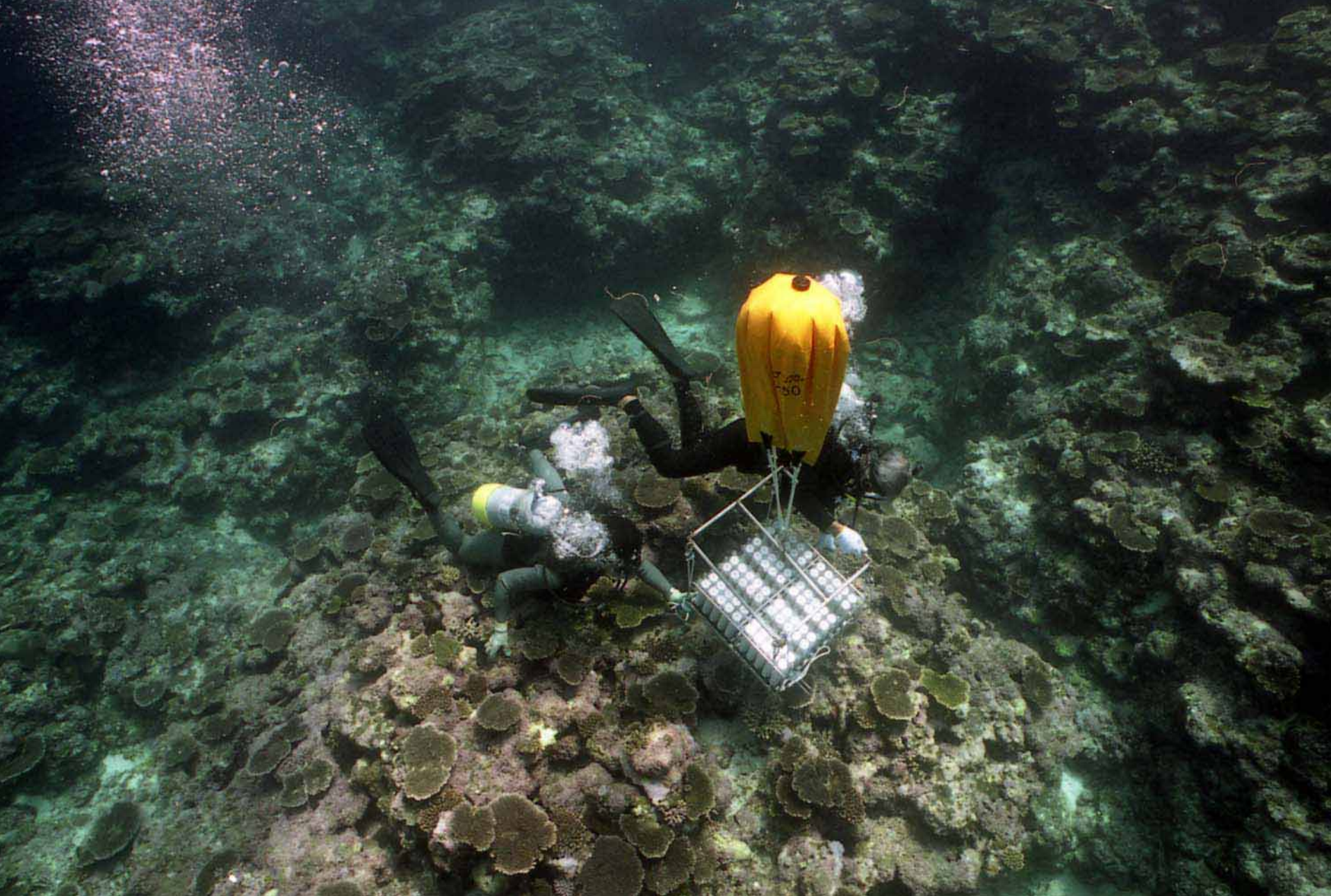
幼生着生適地を選定し、一斉産卵前に着床具架台を設置 (960個型)
